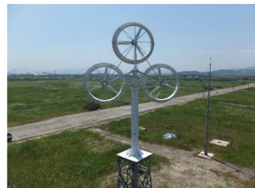
9kW マルチレンズ風車の野外実験
